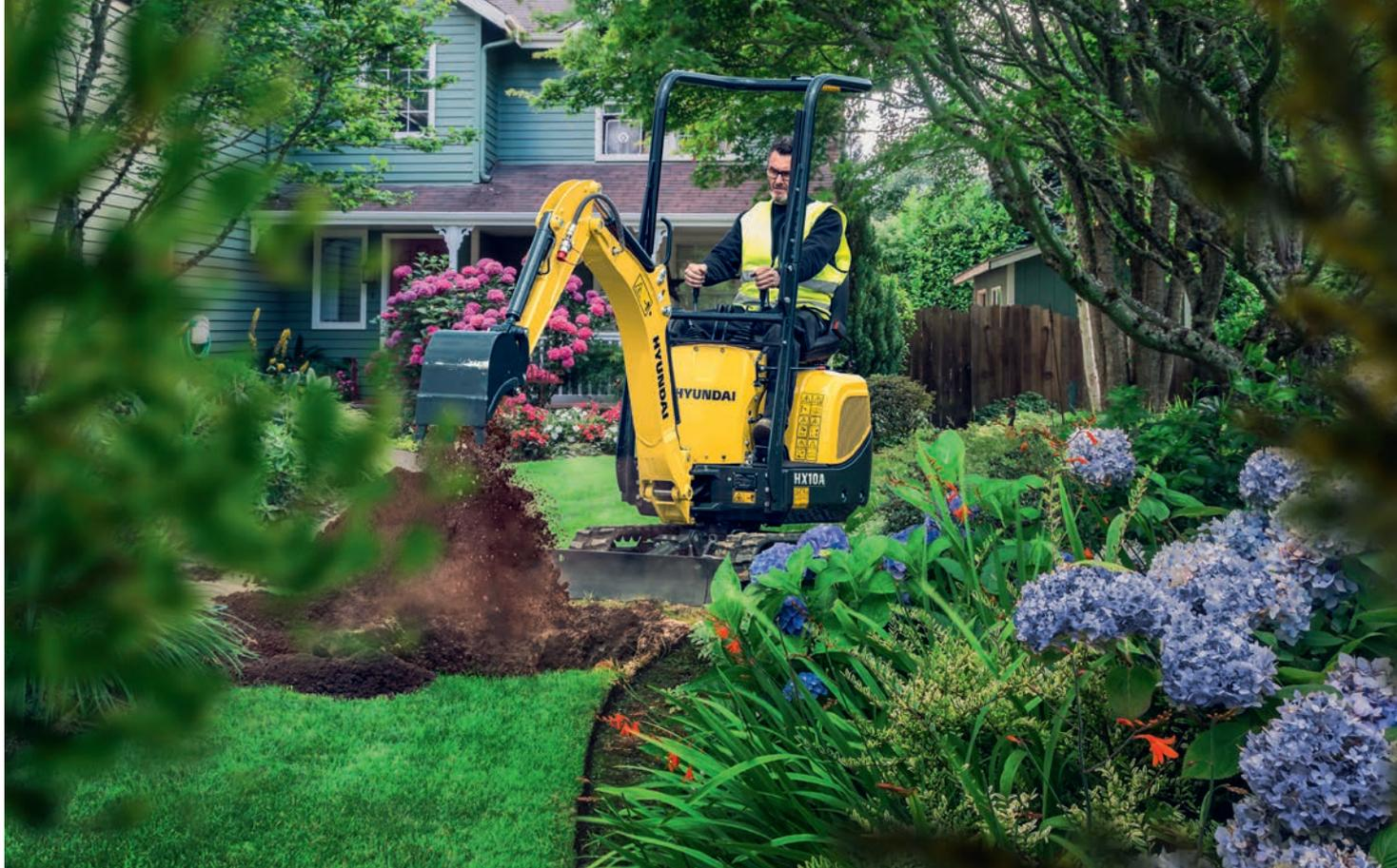
**Kleinere Erd- und Planierarbeiten, Gruben und Gräben ausheben, Zaunlöcher bohren oder Wurzeln entfernen – die Mikrobagger sind auf engstem Raum einsetzbar und sehr wendig, und deshalb überaus vielfältig im Gartenbau und bei Wartungs- und Instandsetzungsarbeiten einsetzbar.**
