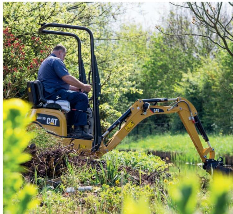
Beim Caterpillar 300.9D sind die Hydraulikzylinder geschützt auf der Oberseite der Auslegerglieder angeordnet.
