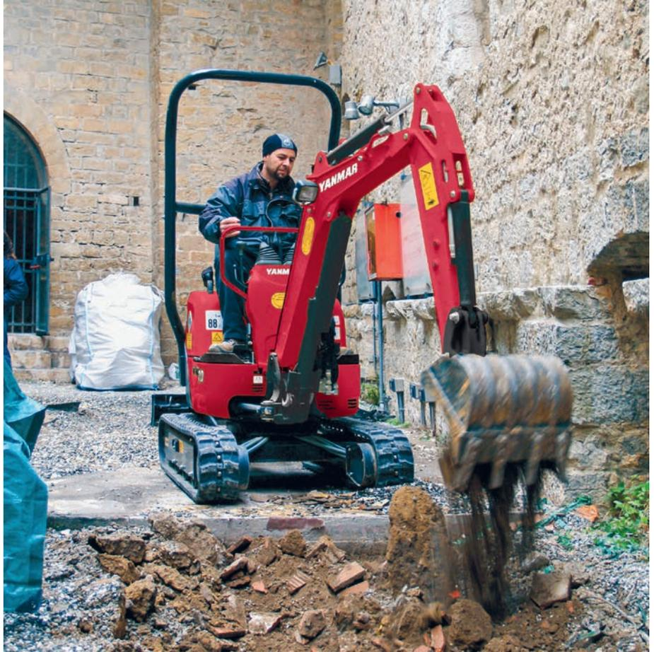
Der Nullheckbagger Yanmar ViO 10-2a macht nicht nur draussen, sondern auch in beengten Innenräumen eine gute Figur.
