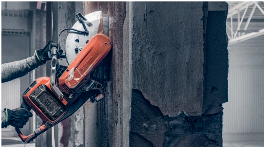
Richtig viel Leistung steckt in diesem Trennschleifer aus dem neuen Pace-Programm von Husqvarna-Construction. Die Akkus haben 94 Volt Betriebsspannung. Foto: Husqvarna
