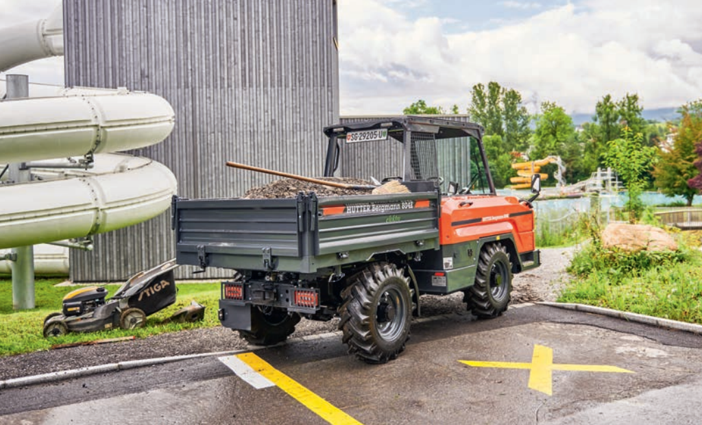
Wahlweise für Baustellen- oder Kommunaleinsätze eignet sich der City-Raddumper Hutter Bermann 804e. Er schafft drei Tonnen Nutzlast pro Fuhrer. Foto: Hutter Bauaschinen AG
