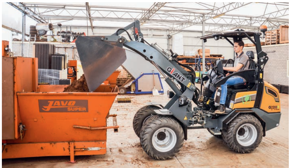
Vom niederländischen Hersteller Tobroco stammt der kompakte Radlader Giant G2200E X-TRA mit seinem besonders niedrig angelenkten Hubgerüst. Foto: Tobroco
