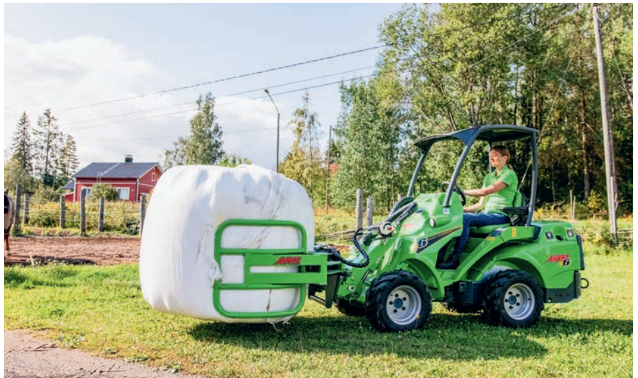
Für lärm- und luft sensible Umgebungen im Freien sowie Innenbereiche eignet sich der Kompaktradlader Avant e6 mit Lithium-Ionen-Akku. Foto: Avant
