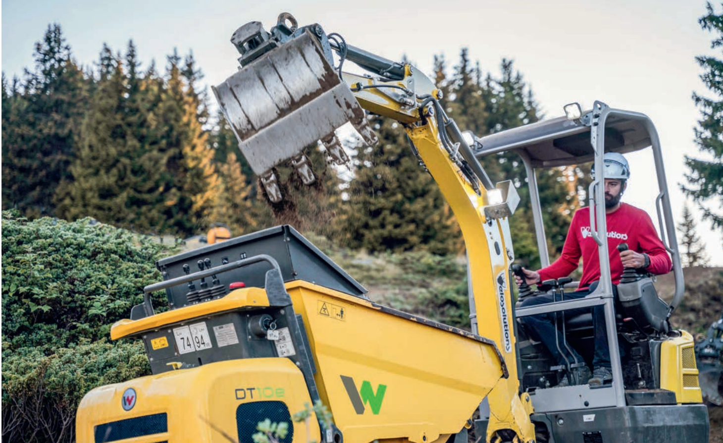
Durch die tief verbauten Akkus, von denen der Elektro-Kettendumper DT10e von Wacker Neuson gleich zwei Stück aufweisen kann, ist er sehr standsicher, selbst in der Schräglage. Foto: Wacker Neuson
