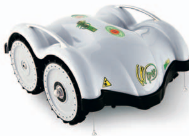
Auch der Wiper Blitz XP (Zucchetti) besitzt Gras- sowie zusätzliche Abgrundsensoren - das Verlegen eines Begrenzungsdrahts erübrigt sich.
