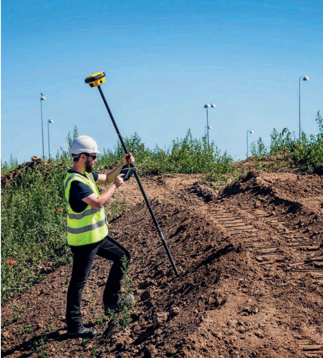
Den Lotstock muss man bei einer Messung nicht senkrecht halten. Bei jeder Messung wird der Neigungswert gespeichert und beglichen.
