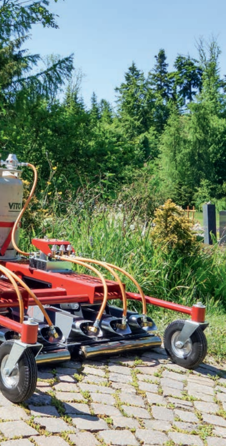
Links: Heissluft- und Abflammergeräte sollen langsam über eine Fläche gefahren werden. Foto: InfraWeeder
