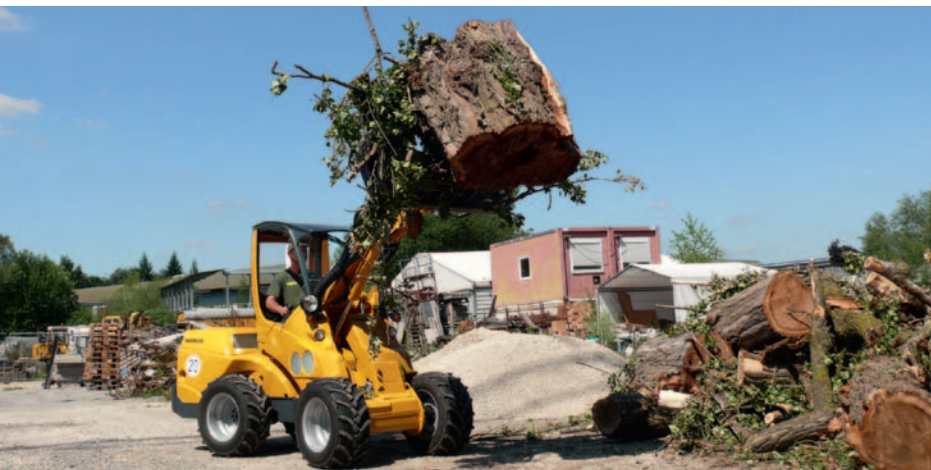
Durch die angehobene Last verändert sich das Fahr- und Kippverhalten erheblich, was grosse Auswirkungen auf die Bedienung der Maschinen hat.
