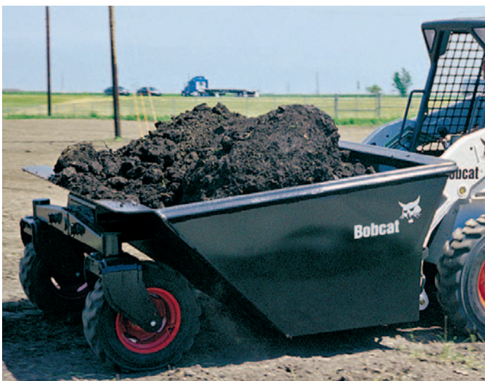
Bild oben: Mit einem zwei Kubikmeter fassenden Anbaukipper wandeln sich Bobcat-Lader zu Dumpern.
