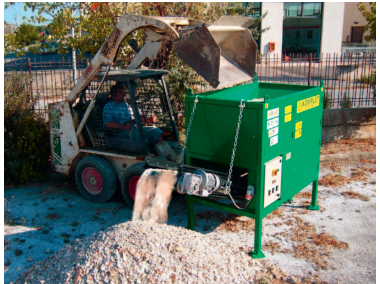
Bild unten: Zerkleinertes Material beansprucht geringeres Volumen als grobes: Dieser Minibrecher zerkleinert stündlich zwei bis fünf Kubikmeter.
