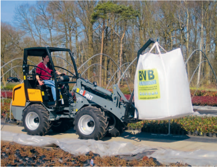
Bild oben: Mit Kranarm samt Pendelschutz am Schnellwechsler befördern Pneulader auch hohe Lasten sicher, da der Schwerpunkt weit unten ist. Bilder rechts: Sehr vielseitig ist der handgeführte Muck Truck, hier als Paletten-transporter und Powerlifter.
