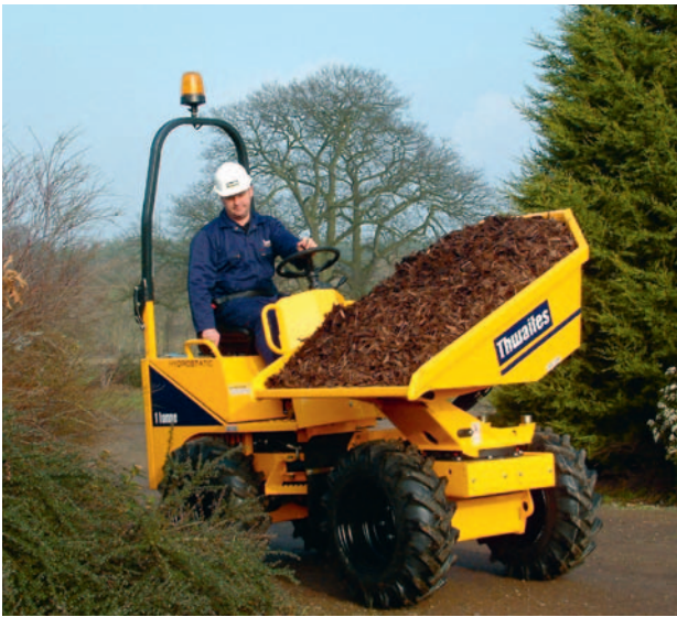
Bild links: Viele unnötige Rangiermanöver lassen sich mit um 90 Grad zur Seite drehbaren Kippmulden vermeiden.
