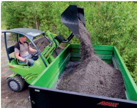
Bild oben: Mit Hochkippschaufel reicht der kleine Avant-Lader zum Beladen problemlos über hohe Bordwände.
