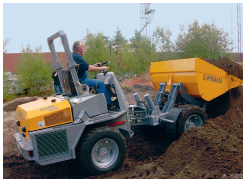
Bild oben: Mit einem zwei Kubikmeter fassenden Anbaukipper wandeln sich Bobcat-Lader zu Dumpern.
