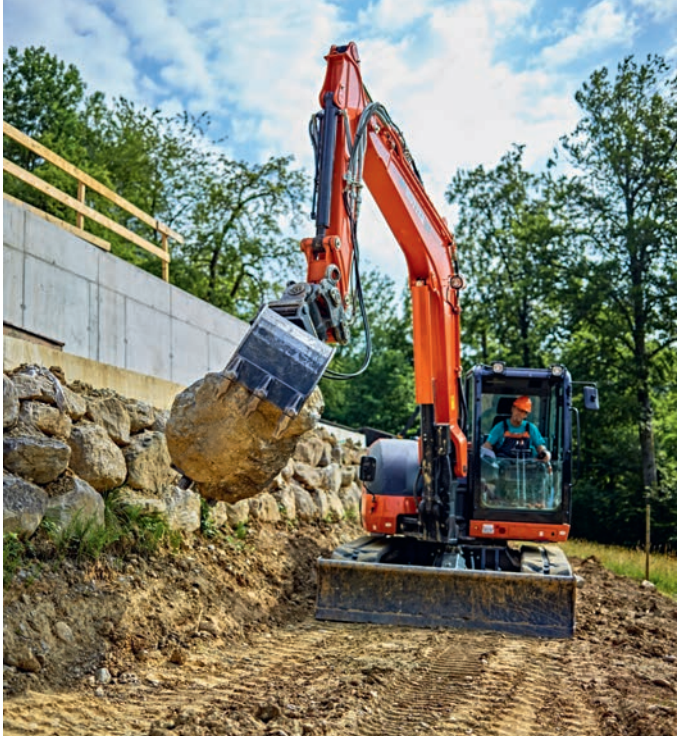
Hutter Baumaschinen (Bild links) macht Kubota-Bagger auf Wunsch besonders beweglich – etwa mit dem PowerTilt (Bild links) oder dem SwingRotorator ohne Zylinder. Besser ohne Zylinder – nach diesem Motto bauen Hersteller wie HKS ihre Tiltrotatoren (rechts). Ihr Argument: Wo nichts wegsteht, kann auch nichts abreißen.
