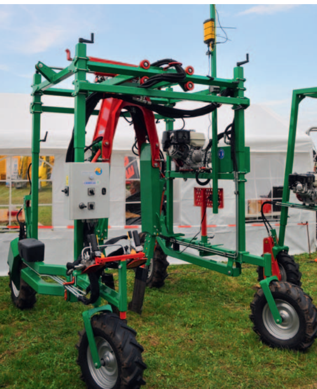
Multi-Tasking kein Problem: Die selbstfahrende Combi-Maschine von Ezendam kann sowohl Pflanzlöcher graben als auch Wurzelballen stechen – aber auch, in einer leicht abgewandelten Form, Gehölze schneiden.
