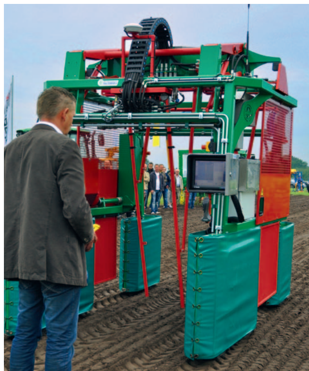
Multi-Tasking kein Problem: Die selbstfahrende Combi-Maschine von Ezendam kann sowohl Pflanzlöcher graben als auch Wurzelballen stechen – aber auch, in einer leicht abgewandelten Form, Gehölze schneiden.
