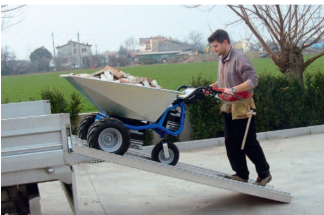
Der elektrische Dumper Jet von Zallys (Golf Services & Technologies F.A. SA, Epagny/Gruyère) trägt 500 Kilogramm, bewältigt schwerstes Gelände und befährt mit Ladung bis zu 30 Prozent Steigung.
