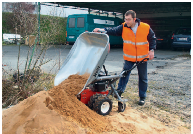
Beim Multi-Dumper MC140 von PowerPac (Niafil AG, Wilchingen) sind Wanne und Rahmen voneinander getrennt, weshalb mechanisch per Handgriff dosiert und gezielt abgekippt werden kann.
