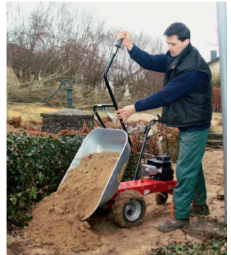
Mit 100 Kilogramm Zuladung ist die Carry 450E von Eurosystems (Hans-Peter Abt Landmaschinen, Ziefen) eine der kleinsten Motorschubkarren.
