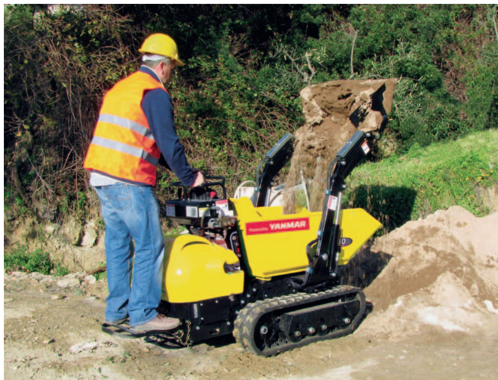
Selbstladedumper wie der Cormidi C80 (Rohrer-Marti) erübrigen bei vielen Arbeiten einen Radlader oder Minibagger für die Beladung.
