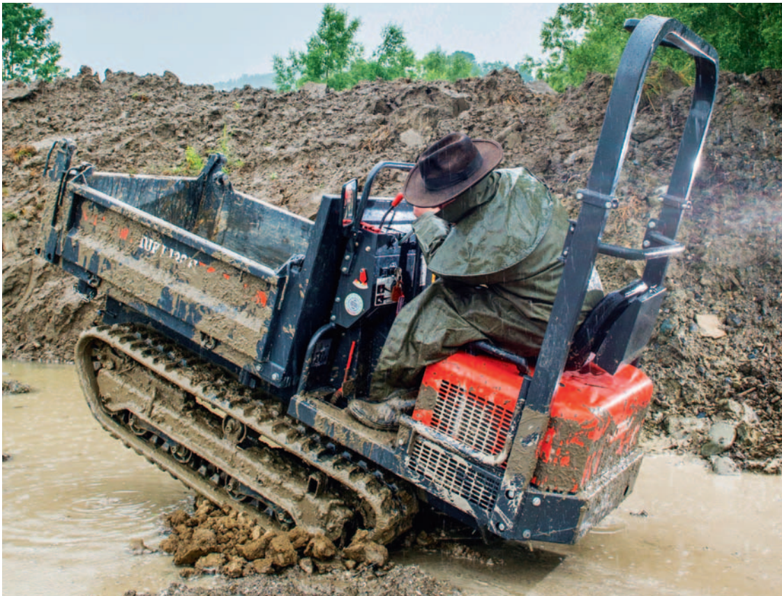
Schweres Gelände ist für den 1,2 Tonnen tragenden Huki 120H von Hutter Baumaschinen keine Hürde; die Huki gelten als «treue Kumpel für den Gartenbau».
