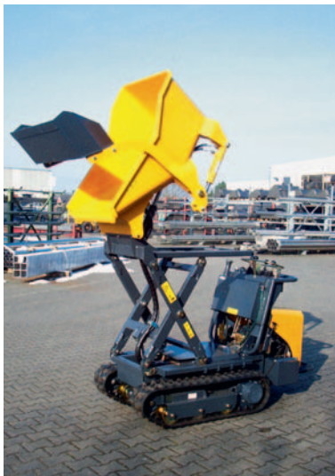
Der r8hx von Hand Baumaschinen (Bild links) kann seine Mulde nicht nur selbst beladen, sondern bei Bedarf auch über hohe Bordwände in Container oder Transporter abschütten.
