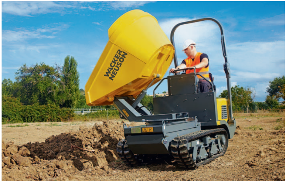
Der 1,5 Tonnen ladende DT15 von Wacker Neuson kippt mit seiner Drehmulde platzsparend ab und erspart so zeitraubende Rangiermanöver.
