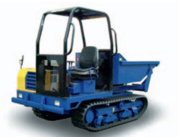
Canycom S25A (Kuhn Schweiz AG) mit sicherem ROPS-Schutz für den Fahrer, Drehfahrerstand für Shuttlebetrieb ohne Wendemanöver, Selbstladeschaufel und Drehmulde.
