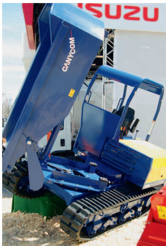
Canycom S25A (Kuhn Schweiz AG) mit sicherem ROPS-Schutz für den Fahrer, Drehfahrerstand für Shuttlebetrieb ohne Wendemanöver, Selbstladeschaufel und Drehmulde.
