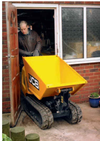
Der r8hx von Hand Baumaschinen (Bild links) kann seine Mulde nicht nur selbst beladen, sondern bei Bedarf auch über hohe Bordwände in Container oder Transporter abschütten.
