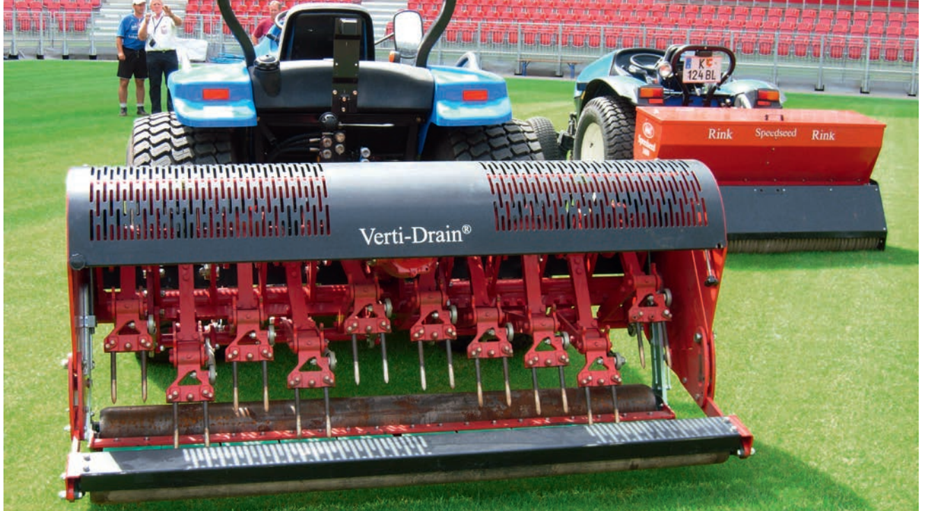
Anbaugeräte wie hier von Verti-Drain® mit Vollspoons (vierrippig) kommen hauptsächlich auf grossen Sport- und Golfanlagen zum Einsatz.
