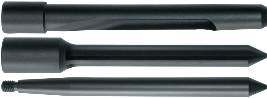
Oben: Hohlmesser zum Pfropfenrausziehen und Auffüllen mit Sand Mitte: Der Kreuzspoon zum Aufbrechen der Verdichtungen in zwei Richtungen Unten: Vollspoon zum Einbringen von Löchern nach dem Verdrängungsprinzip
