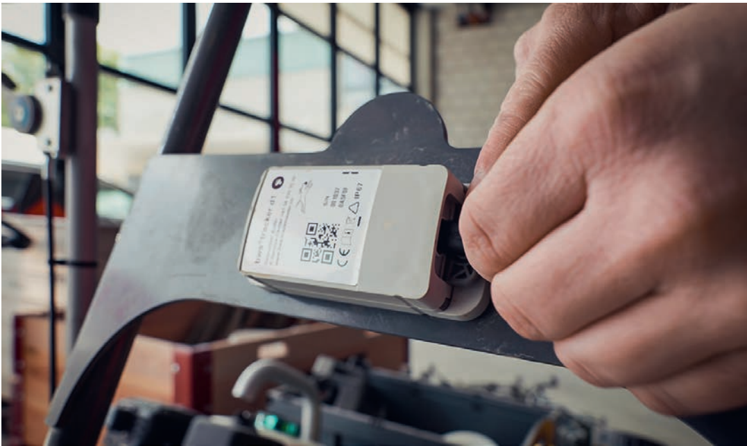
Anbaugeräte wie der Bagger-Anbaumagnet von Egli sind wertvoll genug, dass man sie mit Ortungshilfen wie dem BWS-Tracker ausrüstet. Der Anbieter Debrunner Acifer bietet ihn zusammen mit der Softwarelösung BWS-Trackmaster.
